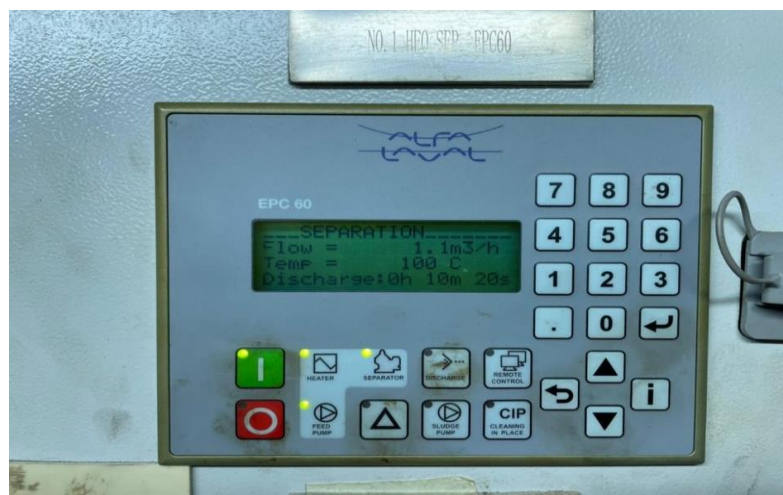
Slika 62. Prikaz podesivog, maksimalno smanjenog protoka kroz separator goriva upotrebom kalibrisanih umetaka
