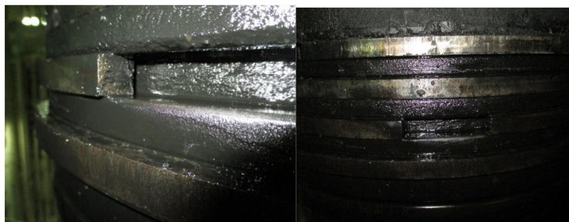
Slika 39. Oštećenja klipnog prstena kod motora u eksploataciji
