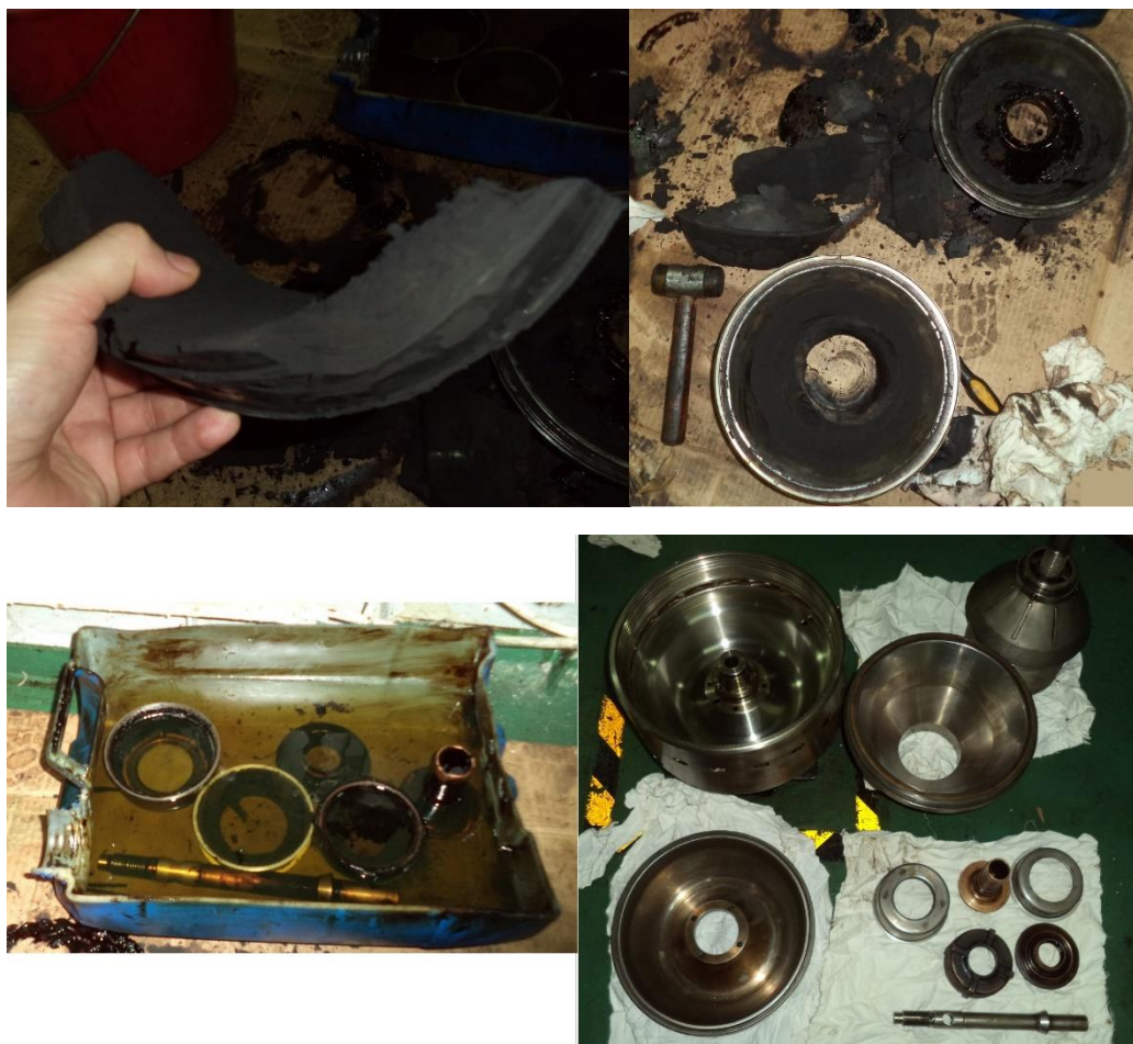
Slika 70. Akumulirane nečistoće na separatoru goriva i očišćeni djelovi separatora
