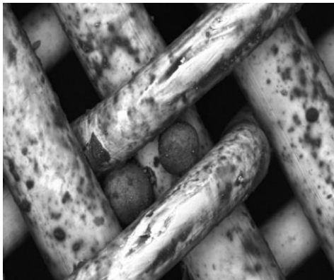
Slika 66. Mikroskopska slika katalitičkih nečistoća zarobljenih u mrežici filtera goriva
